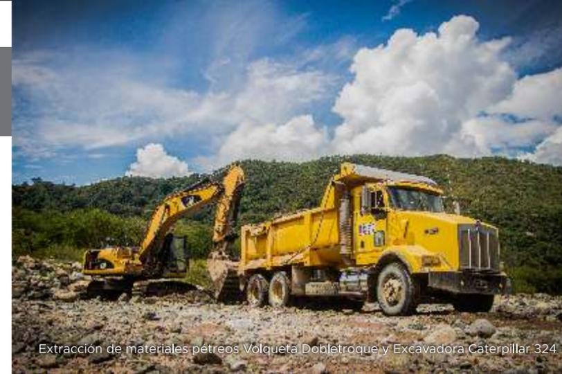
Extracción de materiales pétreos Volqueta Doble Troque y Excavadora Caterpillar 324
